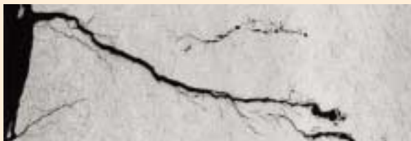
オーステナイトステンレス鋼の応力腐食割れ
