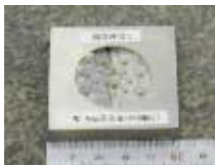
精密鑄造金型 (W-Mo基合金、42HRC)
