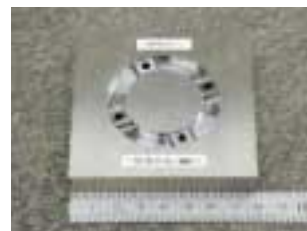
プラスチック成型金型 (SKD11、58HRC)
