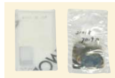
左は防錆フィルムに鉄材と水を封入して放置したものの半年たっても全く錆びていない。 右は通常のビニールシートに鉄材を封入したもの。
