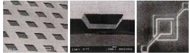
有機薄膜の各種微細加工技術の検討と小型素子の試作開発 ( Siウエハ上に異方性エッチングされたパターンアレイ、パターン断面、音響センサー電極パターン 左より )
