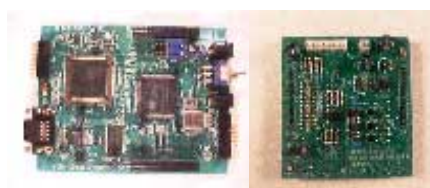
ブラシレスモータ用センサレス制御回路の開発 (DSPを使用したモータコントローラ(左)とモータドライバ(右))
