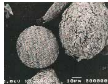
福島県産白土の高度利用 (酸化チタン(硫酸チタン( ))被覆マールライト)
