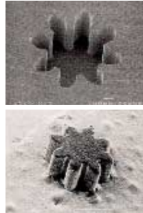
微細放電加工による微細モールド金型の試作 (上：金型、下：成形品)
