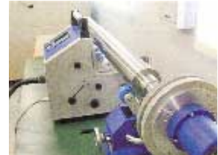
大型円筒用真円度測定機の開発 (試作した真円度測定機)
